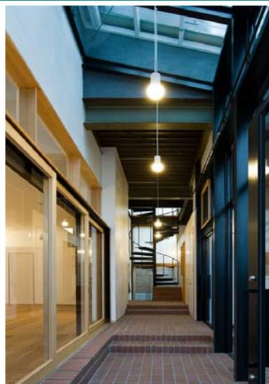
築35年町工場のリノベーション。工場が住まいへ生まれ変わる。既存をそのまま生かし「古いモノ」と「新たに付加したモノ」が明確に区別されながら同居する空間とした。性能についても「既存が担う性能」と「新たに付加する性能」で役割分担している。既設と新設の中間領域を熱環境の緩衝帯としパッシブな空調を行った。
