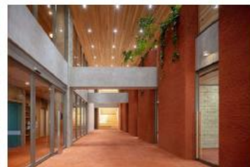
建設残土を用いた土壁や吉野杉などの自然素材を用いたエントラン
