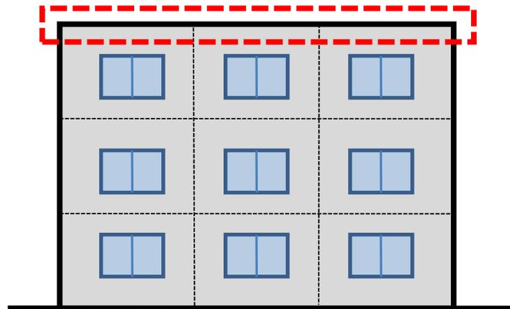
断熱材の最低使用量は  $2.5\text{m}^3 \times 3\text{戸分} = 7.5\text{m}^3$
