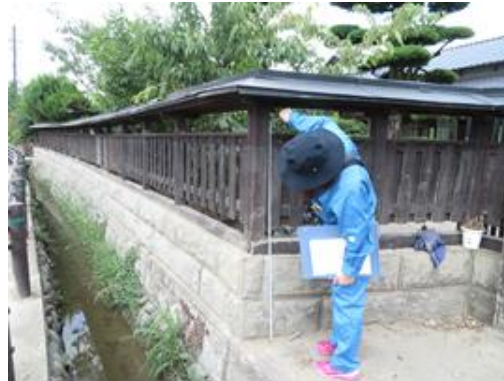
浸水高を計測
