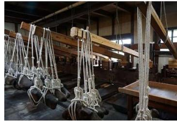
階下中央部は「製法場」という作業場となっており、天秤形状の压榨機（国の重要有形民俗文化財にも指定されている「押し舟」）が並んでいる。押場内の壁は土壁及び漆喰壁となっており、酵母菌が付着している為、塗替えは行われない。
