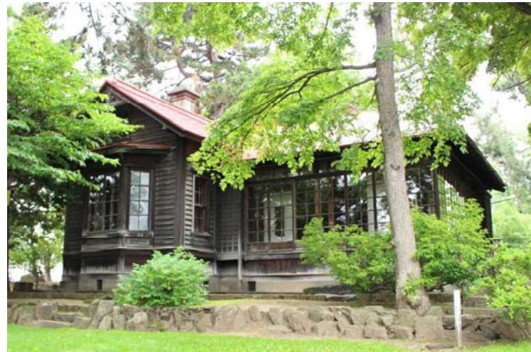
この建物は、全体に洋風の造りの中で、至る所に和風の様式を調和させている和洋両様式を取り入れた古い建物である。自然条件の厳しい北海道で百有余年を生き抜いてきた。使用されている建材は全て道産材で、トドマツやアカマツである。土台の石や玄関のたたきには札幌軟石が使われている。また外壁は、板一枚重ね合わせた「下見板張り」になつておらず、隙間風などが入らず、寒地型の外壁の造りになっている。
