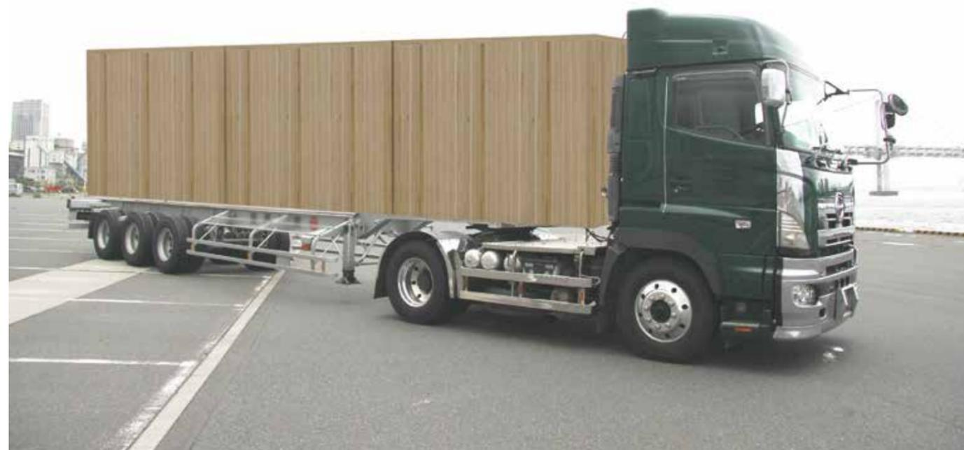
木ボックスの大きさは基本的に幅3.6m、奥行2.4m、高さ3mとします。これは運動会に使うテントなどと同じサイズで、長距離輸送に適したサイズです。木造ビレッジプラザは単一の木ボックスで多様な空間を作る提案です。
