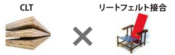
リートフェルト接合はデカルト座標接合とも呼ばれ、互いに直交する三本の材の軸をずらして配置し、それぞれの面と小口をビスや金物により固定するという接合法である。これを用いて、CLTによるリートフェルト接合システムの利用を提案する。
