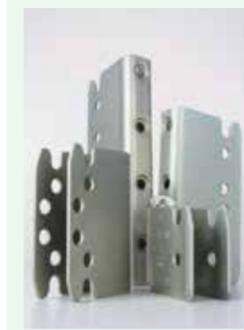
部材同士の接合部は、一般住宅用に流通している金物工法用の梁受金物、ホゾパイプ、長ビスを用いる。そのため、接合部にはスリットとホゾパイプ、ボルト、ドリフトピンやビスの孔が残るだけなので、移設再利用の際には解体と再組み立てが容易となる。ばらして部材を住宅部品として再利用する際も端部加工部分をカットすればそのまま使用できる。
