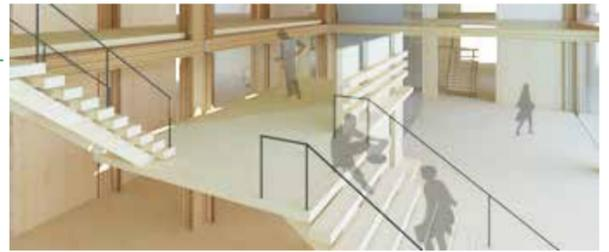
本構法ではXYZ軸上で自由にCLTパネルを配置できるため用途に合わせてフレキシブルに空間を構成できる。本提案においてはその利点を活かし、吹き抜け部分に本構法によって中間階を複数設けることで上下階を緩やかに繋いでいる。
