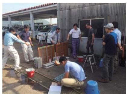
写真5 防火塗料の燃焼実験
