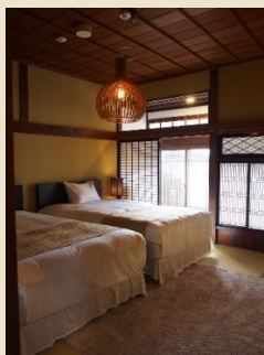
「新宅B」寝室 畳の上にシモンズのセミダブルのベッドが新鮮。障子や書院の格子のデザインや竿縁天井が空間を引き締めている。 機能面では、断熱工事は随所にされており、古民家再生の課題となる快適性は十分満たされている。長期滞在の旅行者向けにコンセントや収納の配置が細かく考慮されている。
